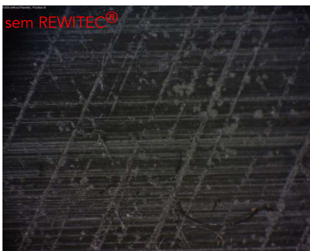
Imagem 4 - turbina K-006 ( sem REWITEC®)
